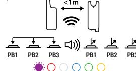
Ako taj recimo ljubičasti kanal želite preskočiti i želite upariti sljedeću boju/kanal onda pritisnite i pustite PB1 tipku i prieđite na sljedeći. Kad je kod prihvaćen ton potvrdje se oglasiti te počinje trepeti sljedeći led i možete krenuti u uparivanje idućeg Tx-D.
